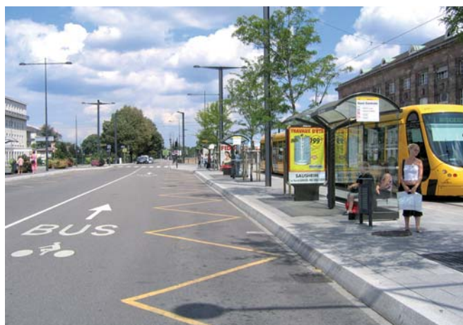
Couloir vélos-bus à contresens
