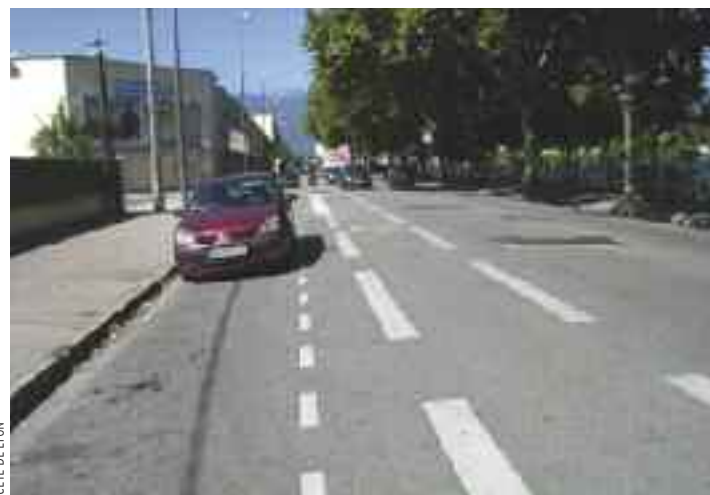
Espace tampon entre la bande cyclable et le stationnement longitudinal.
