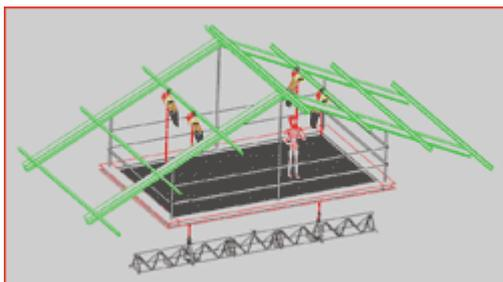
Outre l'aspect novateur du concept, ce produit améliore considérablement les conditions de travail sur le plan sécuritaire. En effet, le filet de sécurité a pour but de permettre au personnel travaillant en charpente d'évoluer en toute sécurité.
