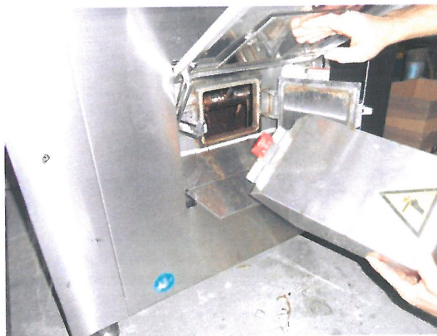
Installer la goulotte de déchargement
