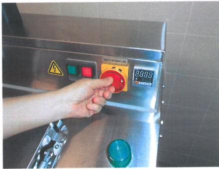
Mettre le sectionneur sur I (on). Puis tourner l'interrupteur sur MARCHE
