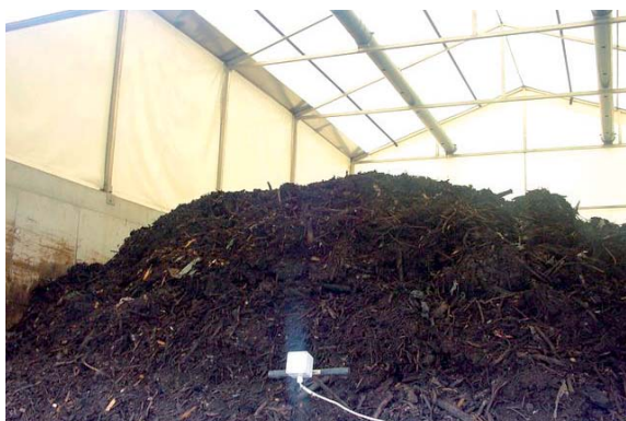
a) Cellule de fermentation sous aération forcée, pilotée par informatique – Plate-forme de co-compostage des boues urbaines de Saint Jean-Brevelay (© Ademe Bretagne)
