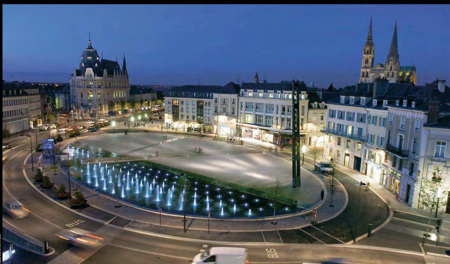
**PLACE DES EPARS À CHARTRES** La place est principalement éclairée à partir d'un mât unique de 18 m de haut supportant neuf projecteurs. Chacun des 96 jets d'eau est illuminé en contre-plongée à partir de quatre appareils immergeables (IP 68) équipés chacun d'une LED intensive à haut rendement. Paysagiste, Jacqueline Osty ; architecte, Reichen & Robert ; concepteur lumière, Roger Narboni/agence Concepto ; matériels d'éclairage, Aubrilam, LEC, Thorn.
