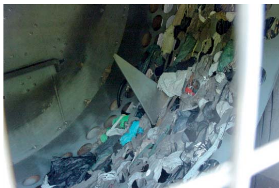
b) Criblage des refus grossiers sur la plate-forme de tri-compostage de Lounay Lantic (© Ademe Bretagne)
