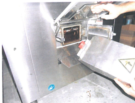
Installer la goulotte de déchargement
