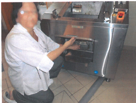
Déverrouiller et ouvrir la trappe de déchargement
