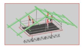
Outre l'aspect novateur du concept, ce produit améliore considérablement les conditions de travail sur le plan sécuritaire. En effet, le filet de sécurité a pour but de permettre au personnel travaillant en charpente d'évoluer en toute sécurité.
