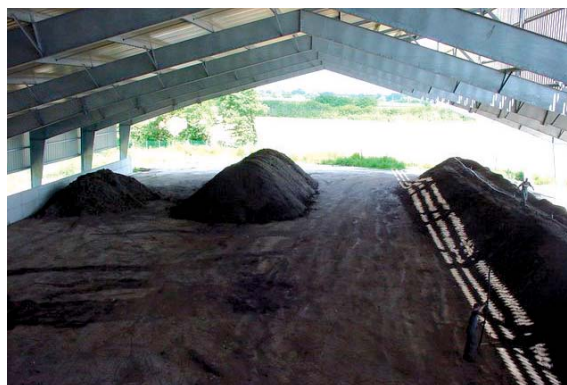
d) Fermentation en andains triangulaires avec 2 retournements par semaine – Plate-forme de tri-compostage des ordures ménagères (OMR) de Launay Lantic (© Ademe Bretagne)
