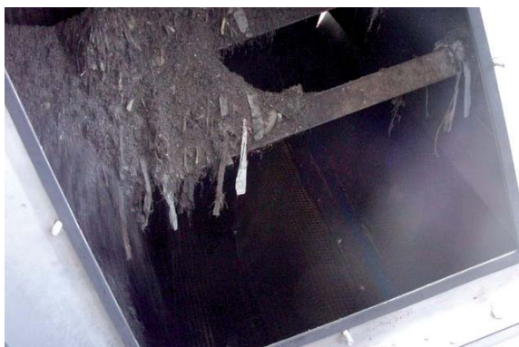
a) Crible Liwell de la plate-forme de tri-compostage de Lounay Lantic (© Ademe Bretagne)
