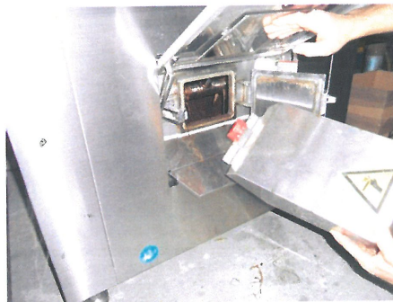
Installer la goulotte de déchargement
