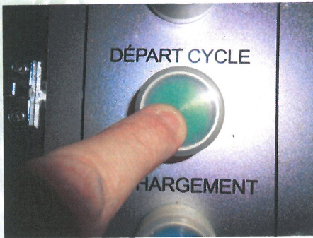
Appuyer sur DEPART CYCLE , les voyants verts s'allument et la machine se met en marche
