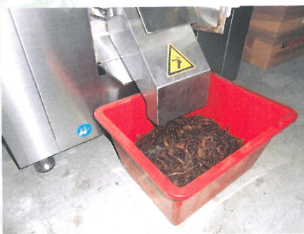
La machine se vide pendant 20 minutes. Mettre l'interrupteur sur ARRÊT et le sectionneur sur O (off). Nettoyer les surfaces et les joints de portes avec de l'eau savonneuse
